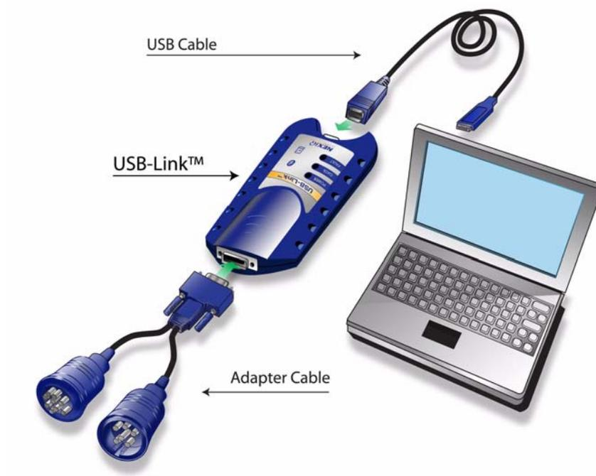
Figure 1.1 *USB-Link™ Components*
